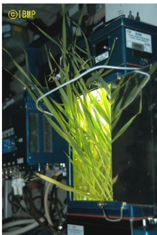
ISSに設置している植物栽培装置LADAで生育する大麦二条(写真提供:IBMP)
